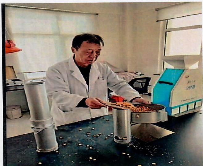
图 12 市中心检验员正在检验玉米容重
