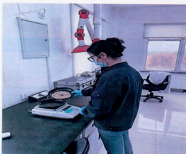
图9 市中心检验员正在称量稻谷样品
